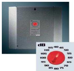
SoundEar : vue de dos et curseur de réglage
